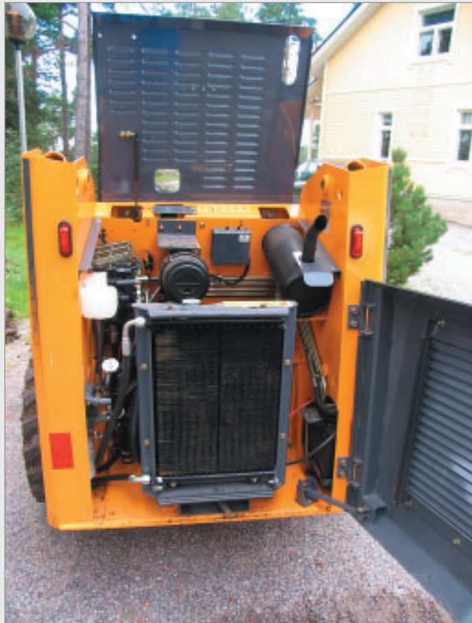
Yanmarin moottori paljastuu kahden huoltoluukun takaa. Jäähdytin ja öljynlauhdutin ovat puhdistettavissa paineilmalla tai vedellä.
