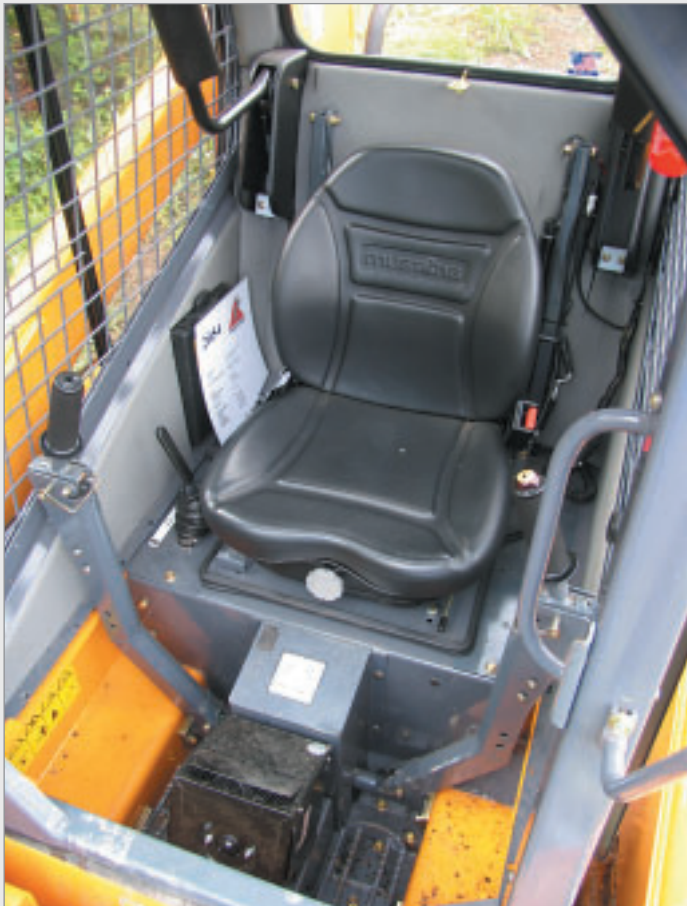
Tämäntyyppisissä koneissa ei liikaa tilaa ole, joskin ohjaamoon kyllä sopii pidempikin kuljettaja. Hallintajärjestelmäksi on useita eri vaihtoehtoja. Koeajokoneessa kuormainta hallittiin jaloilla ja voimansiirtoa vivuilla.
